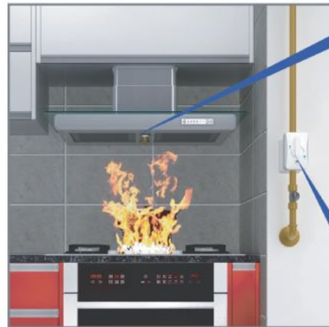
2. пожар -> Обнаружение 100 °C (1-й)
